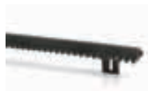
ROA6 CREMAGLIERA M4 25x20x1000 mm ASOLATA IN NYLON CON INSERTO METALLICO. PER CANCELLI DI PESO MAX 500 kg. PZ./CONF. 10
