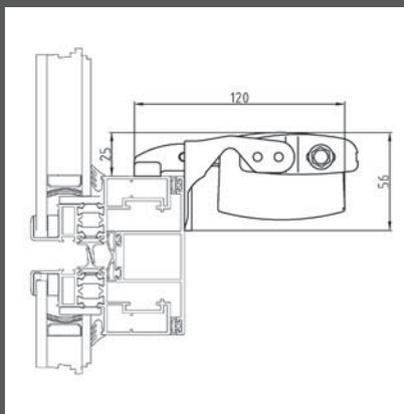
Applicazione su telaio con staffa in dotazione e connettore per anta nascosta
