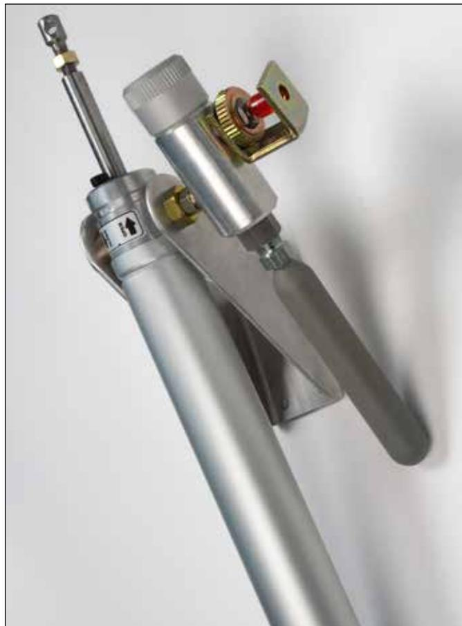
Le valvole hanno la funzione di perforare la bomboletta di CO<sub>2</sub> a seguito di un segnale termico od elettrico (quando è installato l'azionamento elettrico). La CO<sub>2</sub> penetra all'interno del cilindro e provoca l'apertura del serramento.
