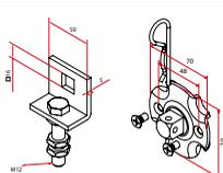
TM2 58 Supporto a omega altezza regolabile con perno quadro
