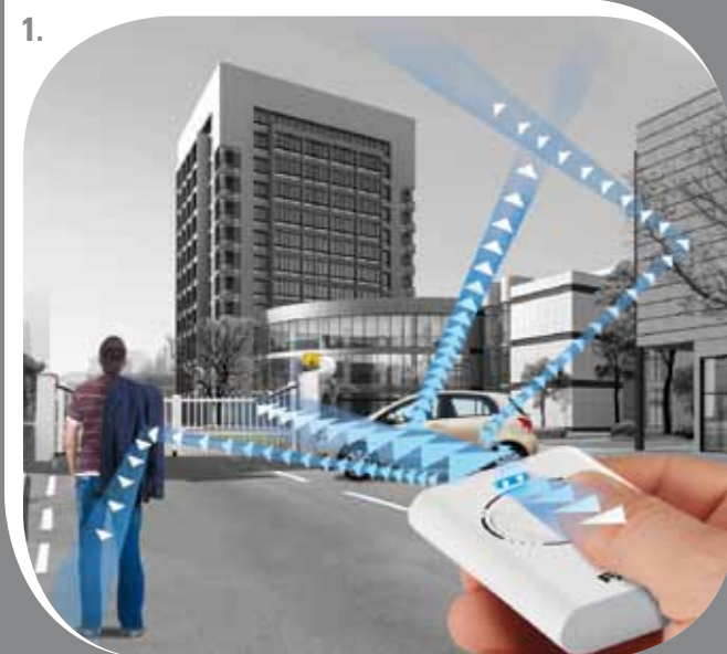
1. Trasmissioni standard: l'ambiente circostante, compresa la mano dell'utente, modifica l'emissione radio e solo una parte della potenza trasmessa arriva al ricevitore.
