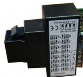
Attivatore prossimità con collegamento su bus RS485
