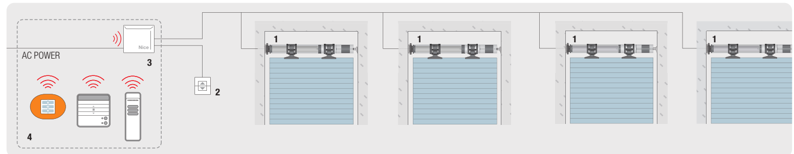
1. MOTORE TUBOLARE 2. PULSANTE "SALI/SCENDI" DI GRUPPO 3. CENTRALE DI COMANDO SERIE MINDY TT4* 4. TRASMETTITORE PER COMANDO DI GRUPPO
